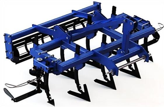
Культиватор навесной виноградниковый является комбинированным гидрофицированным агрегатом с фронтальным и боковым расположением рабочих органов, прицепного типа.
